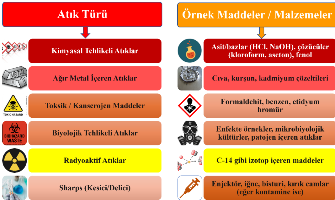
Şekil 8. Laboratuvar tehlikeli atık türleri ve örnekleri
